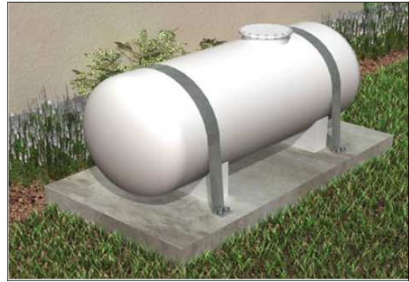
Renforcement du support et ancrage de la cuve
