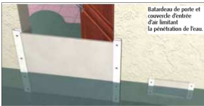
Mise en place d'un batardeau
